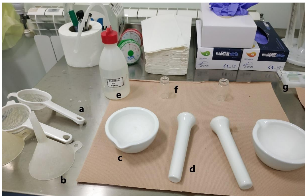
Figura 22 - Material utilizado no método de Willis - Mollay. a) tamis de rede metálica; b) funil; c) almofariz; d) pilão; e) solução saturada de cloreto de sódio (NaCl); f) frasco de vidro de boca larga; g) lamelas. Original.
